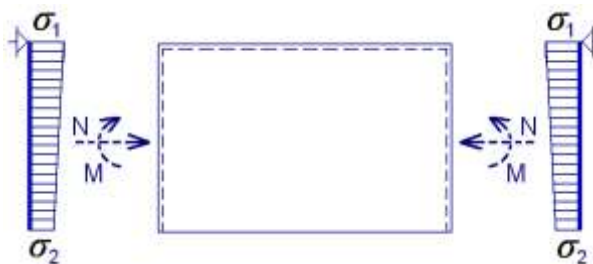
Obr. 1.12: Namáhanie steny kombináciou tlaku a ohybu
