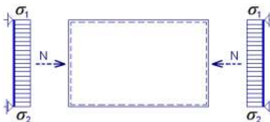
Obr. 1.8: Namáhanie steny tlakom
