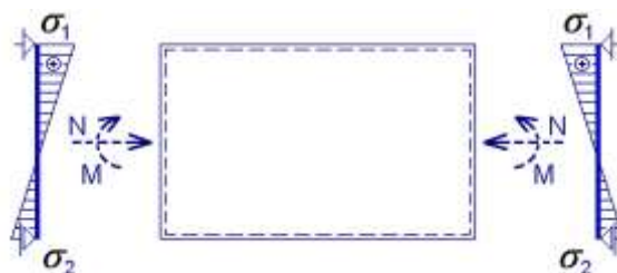
Obr. 1.10: Namáhanie steny kombináciou tlaku a ohybu
