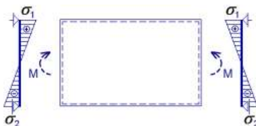
Obr. 1.9: Namáhanie steny ohybom
