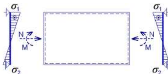
Obr. 1.10: Namáhanie steny kombináciou tlaku a ohybu
