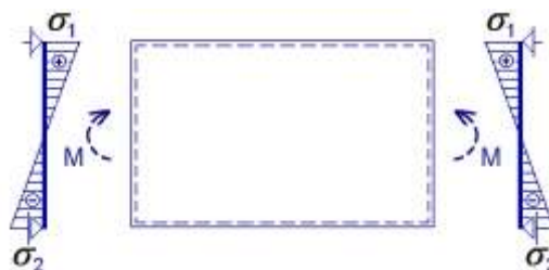
Obr. 1.9: Namáhanie steny ohybom
