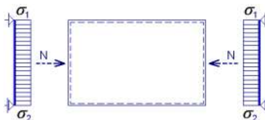
Obr. 1.8: Namáhanie steny tlakom
