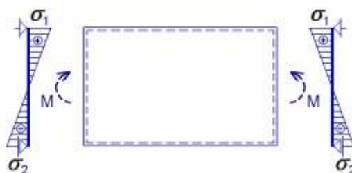
Obr. 1.9: Namáhanie steny ohybom
