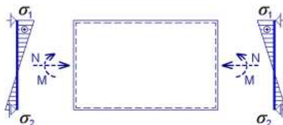
Obr. 1.10: Namáhanie steny kombináciou tlaku a ohybu
